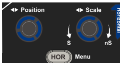
Figura 3-11 Zona di controllo orizzontale
